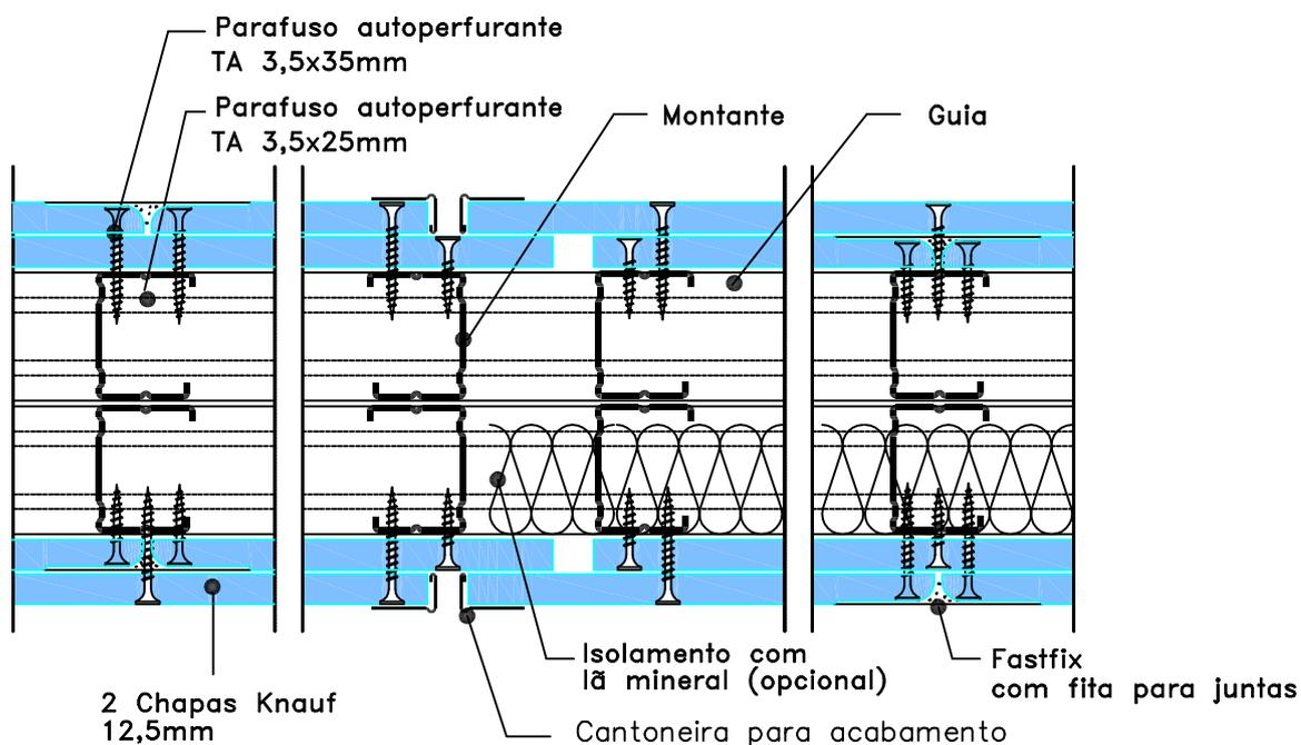
1 DETALHE – JUNTA DE DILATAÇÃO – W115– EMPS
