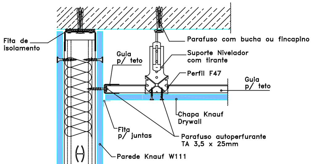
2 CORTE VERTICAL – TETO D112 UNIDIRECIONAL ENCONTRO C/ PAREDE DRYWALL – 1 CHAPA
