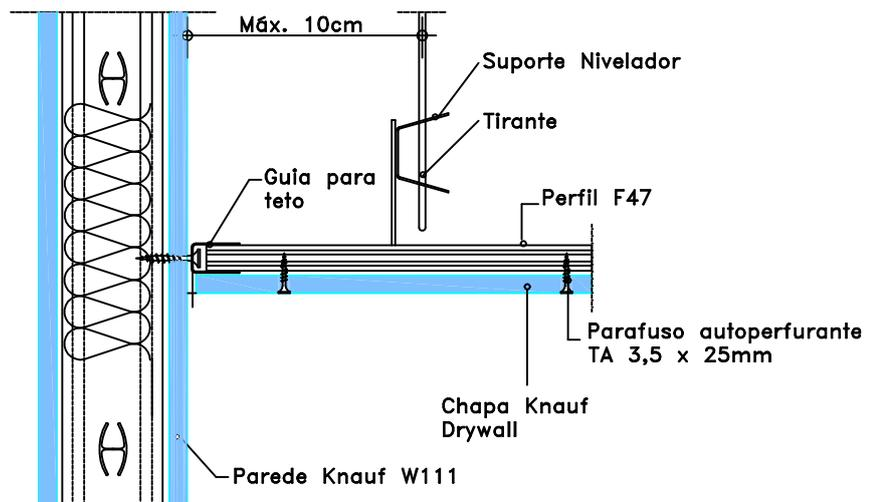
1 CORTE VERTICAL – TETO D112 UNIDIRECIONAL ENCONTRO C/ PAREDE DRYWALL – 1 CHAPA
