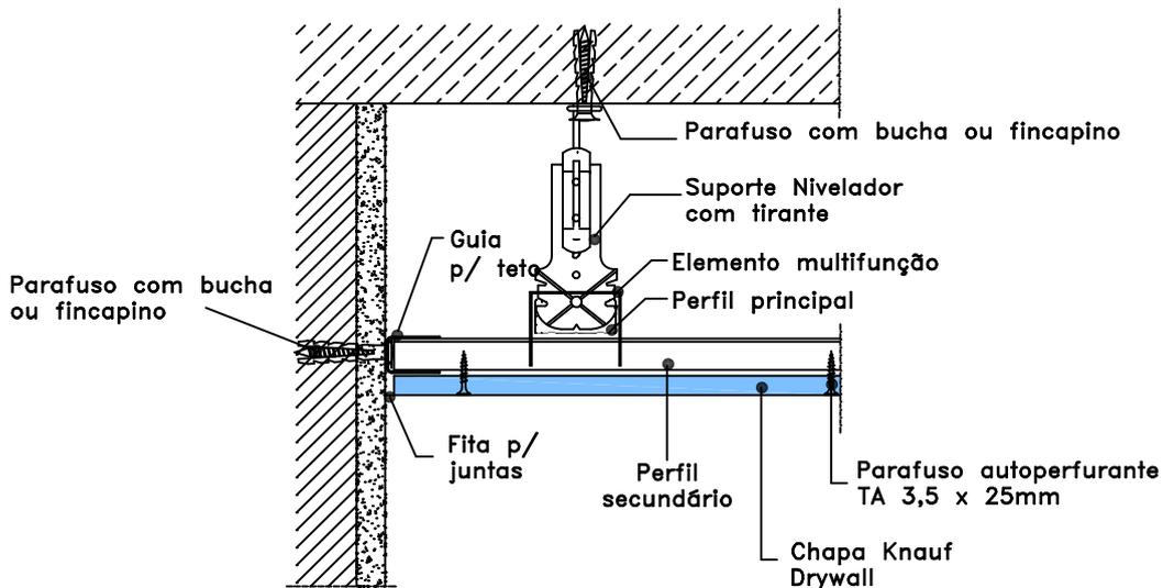
1 CORTE VERTICAL – TETO D112 BIDIRECIONAL ENCONTRO C/ PAREDE MACIÇA – 1 CHAPA
