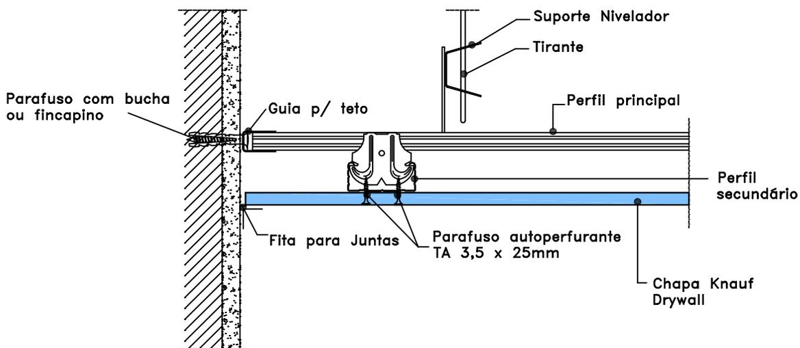
2 CORTE VERTICAL – TETO D112 BIDIRECIONAL ENCONTRO C/ PAREDE MACIÇA – 1 CHAPA
