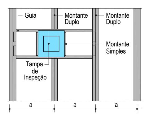
TAMPA - INSTALAÇÃO SECCIONANDO O PERFIL
